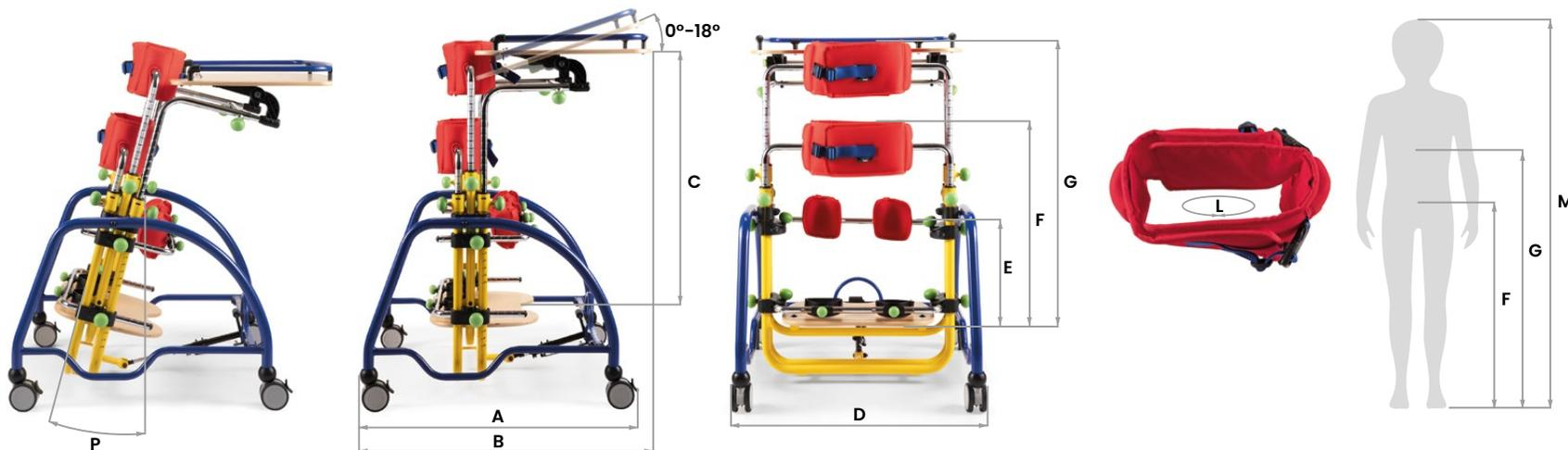
Asegurarse que las alturas F y G representadas en la figura, entren en el rango de medida indicado para el soporte pélvico y torácico.
